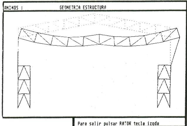
Salida de datos de la estructura en deformación
