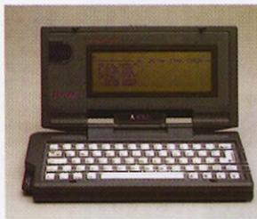
Die technischen Daten des 798 Mark teuren »Portfolio« waren bis vor kurzem »ausgewachsenen« Personal Computern vorbehalten. Atari brachte alle Komponenten des Kraftpakets in einem nur 197x98x26 mm großen Gehäuse unter: einen mit 4,77 MHz getakteten 80C88-Prozessor, einen 128-KByte-Hauptspeicher, der sich auf 640 KByte erweitern läßt, einen 256-KByte-ROM-Speicher und als Massenspeicher ein RAM-Kartenlaufwerk. Dabei wiegt der Portfolio mit Batterien gerade 495 Gramm.
