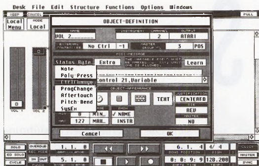
Bild 1. Die Status-Byte-Zuordnung für einen Fader im MIDI-Manager
