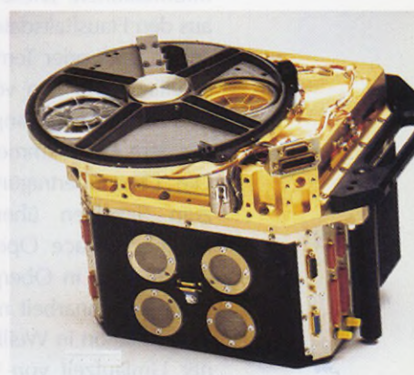
Bild 3. Der positionsempfindliche Proportionalzähler. Bild: MPE
