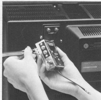
**2.** Conecte el cable corto de doble conductor de la caja de control para TV a la conexión de VHF de su aparato de TV. Si la conexión de VHF de su televisor posee dos bornes de rosca, asegure los dos conductores del cable a los bornes. Si la conexión de VHF de su TV es un borne redondo de rosca, deberá de conectar el cable de la caja de control para TV al adaptador provisto con su aparato de TV.
