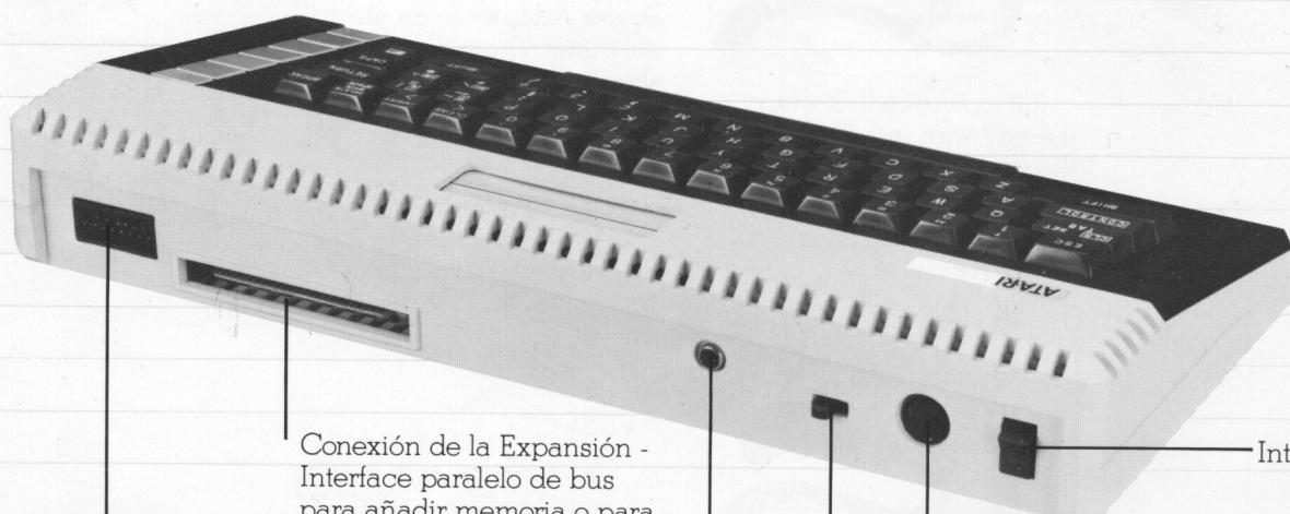
Conexión de la Expansión - Interface paralelo de bus para añadir memoria o para conectar futuros accesorios o equipos periféricos a su sistema de ordenador.
