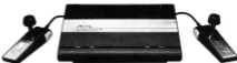
La nuova console per videogiocchi VCS 7800, con risoluzione grafica da 320x192 e compatibile con la "Pascal" software VCS 3600.
