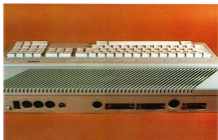
Retro del computer. Da sinistra: tasto RESET, interruttore generale, presa di alimentazione, connettori MIDI IN e MIDI OUT, presa modulatore RF, presa monitor, porta Centronics, porta RS 232, presa drive esterno, porta disco rigido.
