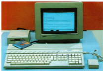
Sistema completo composto da un monitor ad alta risoluzione, un drive da 3,5", computer 520 STM e programma applicativo di elaborazione testi
