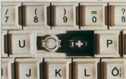
Nach Wunsch kann die originale Gummirückführung auch durch Federn ersetzt werden.
