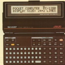
Taschencomputer und Taschenrechner in einem ist der neue Sharp Pocket Computer. Er bietet die Rechengenauigkeit wissenschaftlicher Taschenrechner, einen Basic-Interpreter und bis zu 24 KByte Arbeitsspeicher.
